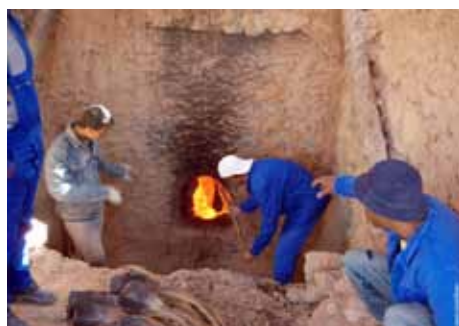
Fig. 66 : Bouche du four à chaux
