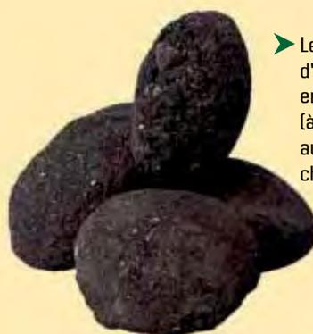
► Les deux produits de l'usine d'agglomération de la mine : la brique, environ 10 kilos (à g.) et les boulets (à d.) ; la première dédiée surtout aux locomotives et les seconds au chauffage domestique
