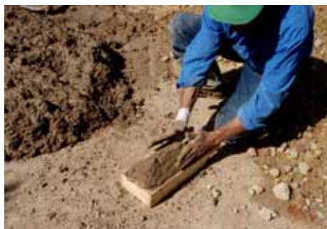
Fig. 30 : Fabrication d'adobes « mixtes »
