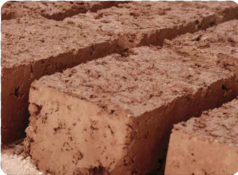
Blocs de terre crue moulés
