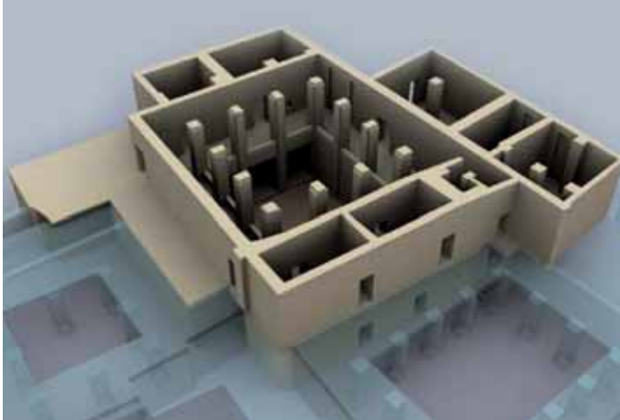
PHASE 7- Structure/Élévation des murs du premier étage en adobe
